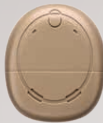
Επεξεργαστής ήχου Kanso CP920, φοριέται εκτός αυτιού και χρησιμοποιεί απλές μπαταρίες.
